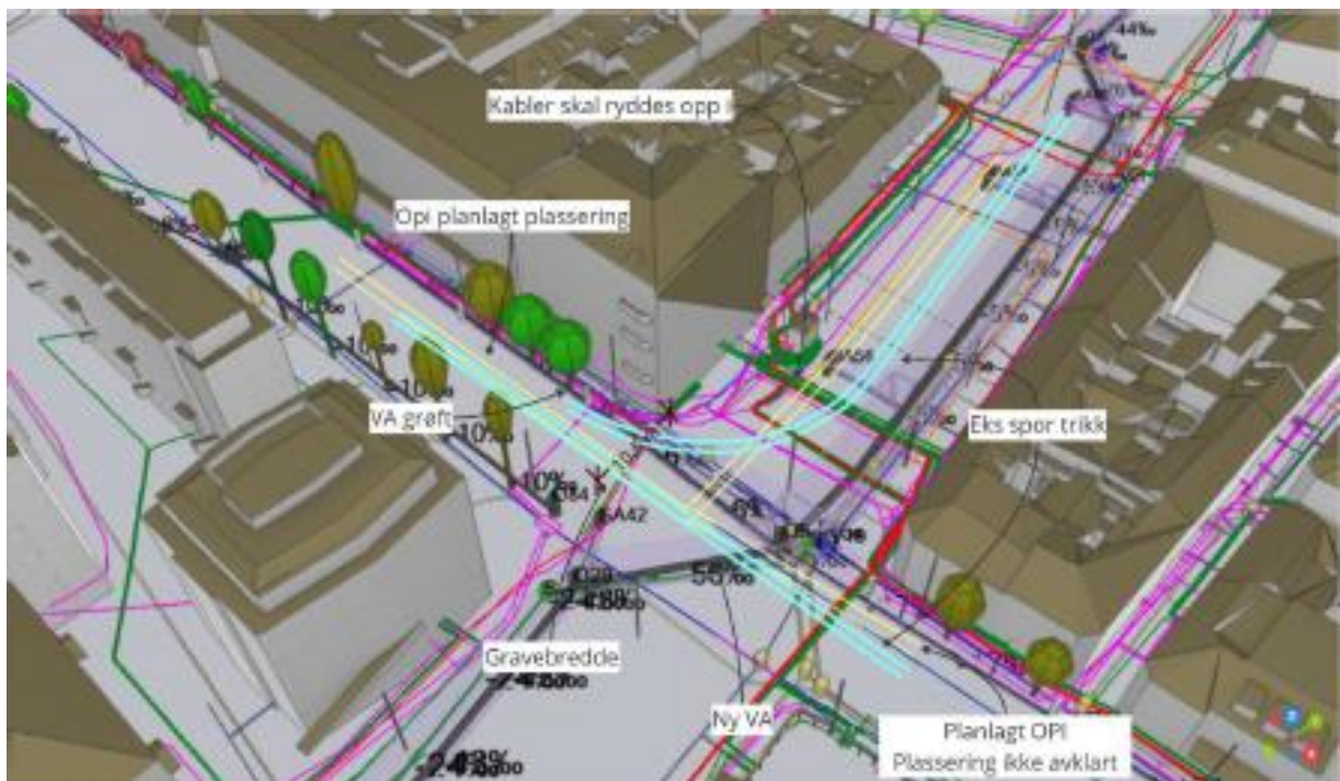
Figur 3. Oversiktsbilde som viser teknisk infrastruktur i bakken, trafostasjon og trikkeskinner
