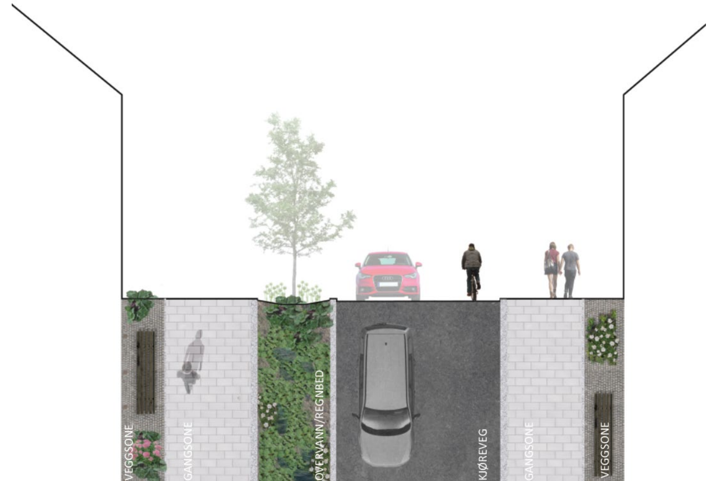
Figur 11 Mulig materialbruk i de ulike sonene i strekningen Kirkegata - Nedre Møllenberg gate, med foreslått overvannsløsning.
