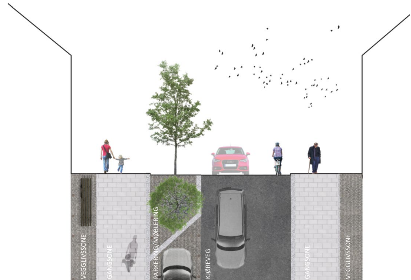
Figur 14 Materialsnitt som viser utforming av parkeringslomme med storgatestein. Illustrasjon: Asplan Viak.
