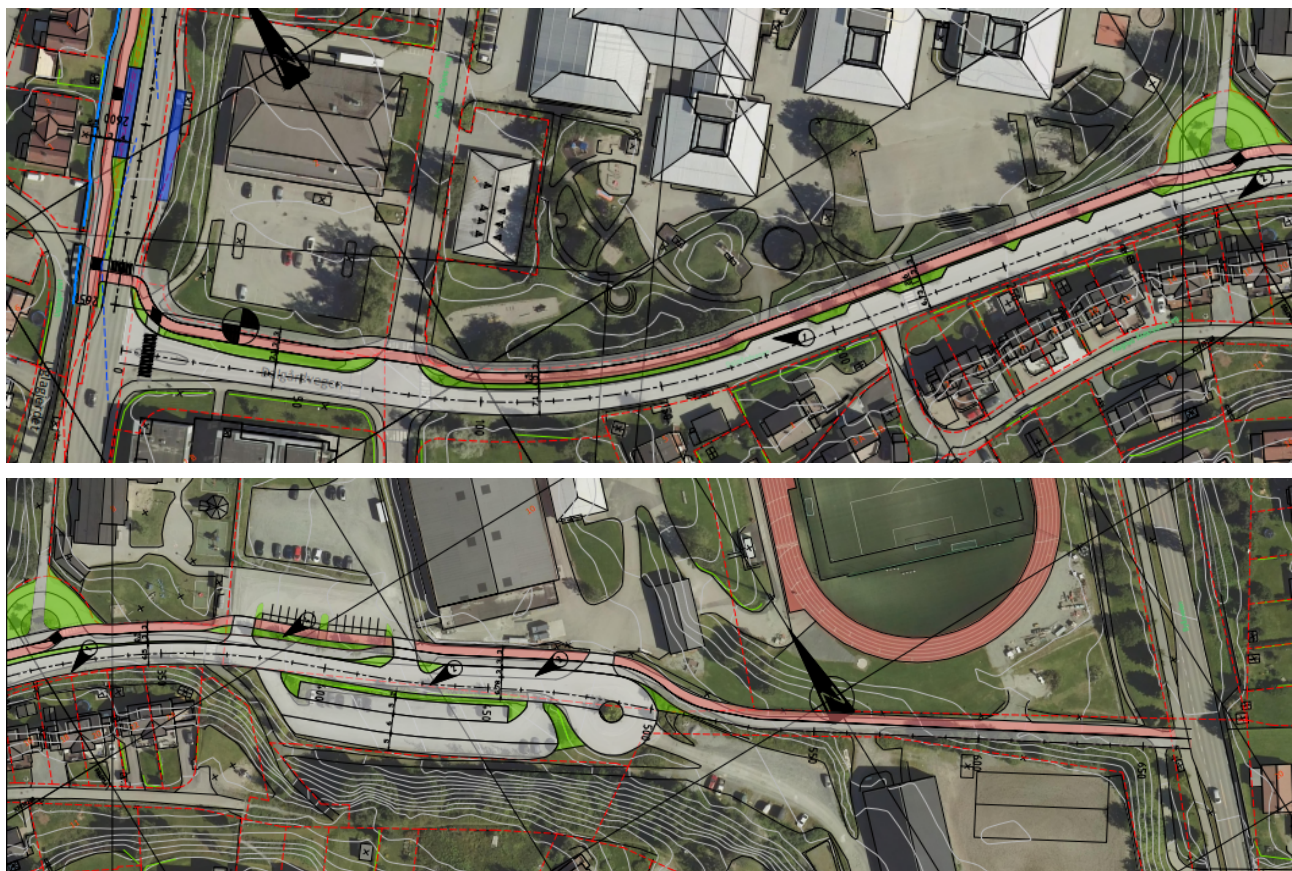
Figur 13: Sykkelveg med fortau langs nordsiden av Dalgårdvegen.
