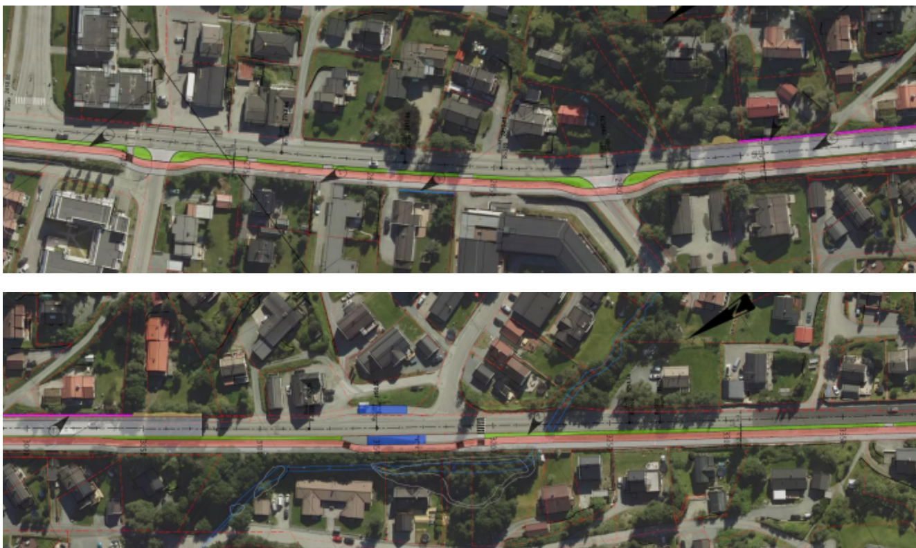
Figur 9: Sykkelveg med fortau langs vestsiden av Odd Husbys veg. Ca 1,5 m av høybrekket sør for Dalgård senkes. Vegen sideforflyttes østover med behov for nye murer (rosa strek).
