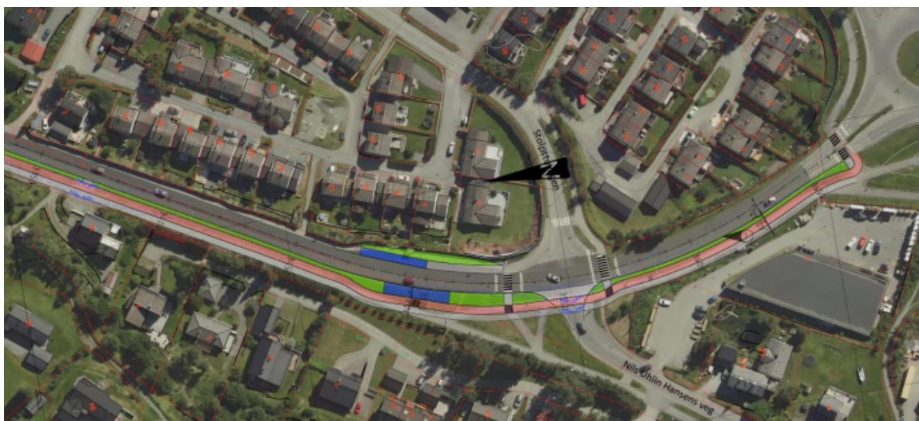
Figur 11: Sykkelveg med fortau langs vestsiden av Odd Husbys veg mot Stavset.
