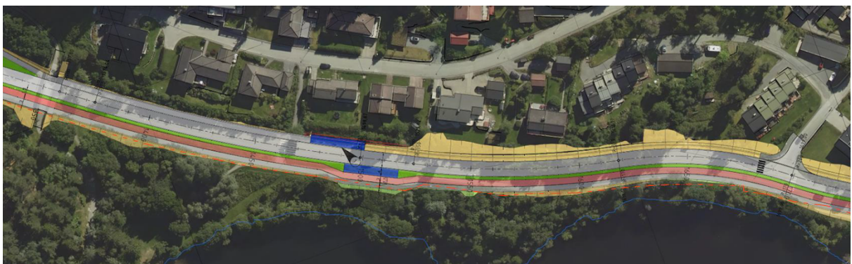
Figur 3: Sykkelveg med fortau legges langs kjørebane med utvidelse østover mot boligene. Gul skravur viser skjæring uten mur. Holdeplass vist i blått. Holdeplass vil ligge nærmere Skavlands veg, enn det som er vist i denne figuren.
