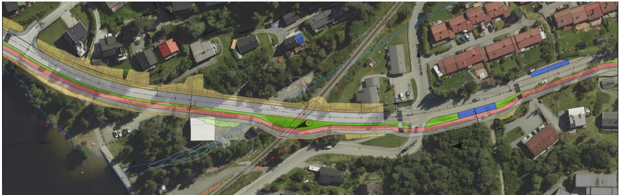
Figur 4: Sykkelveg med fortau legges langs kjørebanen med utvidelse østover mot boligene. Gul skravur viser inngrep på privat eiendom i form av skjæring uten mur.
