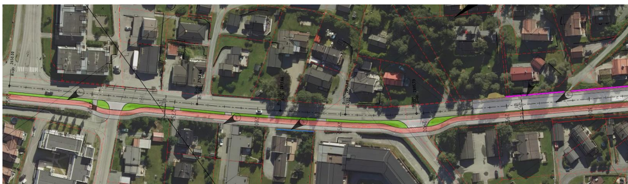
Figur 128: Eksisterende holdeplass ved Dalgård er flyttet nord for krysset. Sykkelvegen er trukket inn 5 m i sideveger
