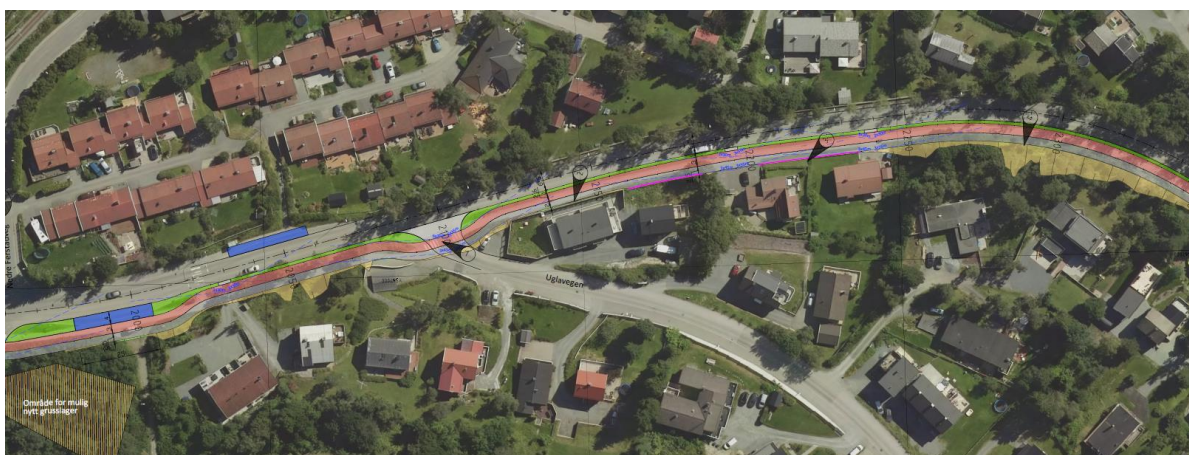
Figur 105: Skisse som viser hvordan sykkelvegen kan løses. Krysset ved Uglavegen strammes opp slik at gangfeltet blir kortere
