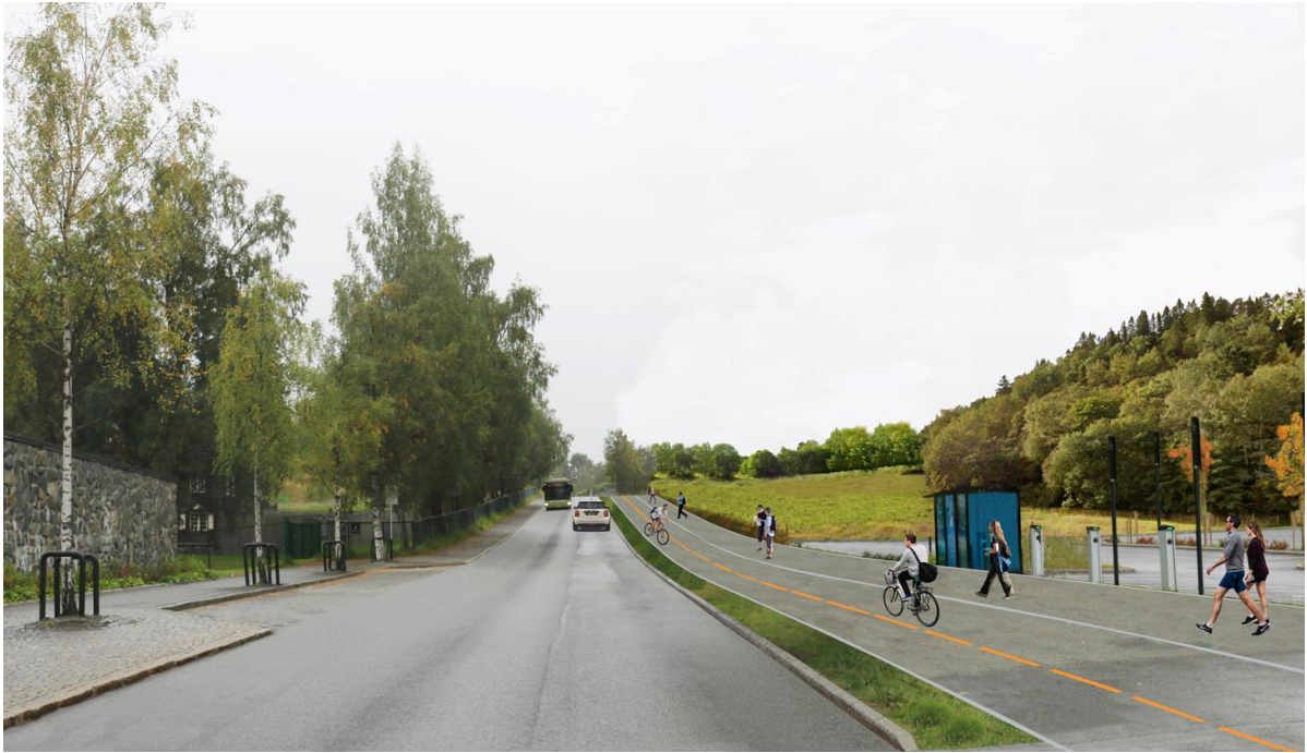
Figur 39: Illustrasjon som viser hvordan gaten blir uten alléen. Hvor mye nyplanting av trær det kan bli, avhenger av om trafikkdeleren er bredere enn 2 m eller ikke. I illustrasjonen er den ca. 1,5 m.
