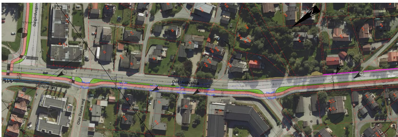
Figur 132: Tilpasset løsning med smal trafikkdelers på minimum 1 m og redusert høybrekk.
