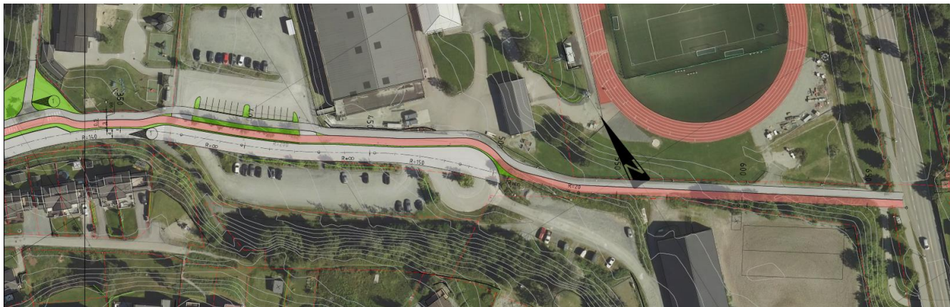
Figur 150: Sykkelveg med fortau kompliserer situasjonen ved idrettsanlegget hvis bussen stopper og slipper av passasjerer i sykkelvegen. I en slik løsning bør det lages bussplattform.
