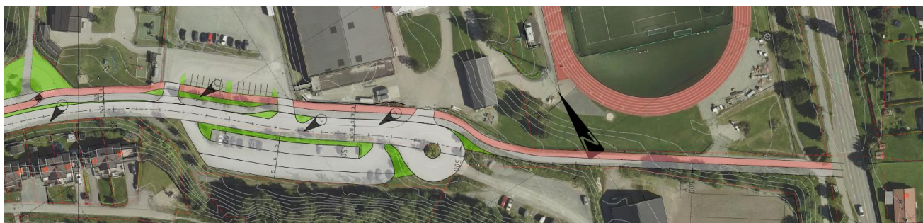
Figur 153: Løsning fra Dalgård skole og ned forbi idrettsanlegget til Byåsveien. For å opprettholde mulighet for bussstopp ved idrettshallen, har sykkelveg og fortau byttet side («switchløsning»)
