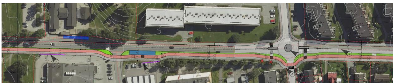
Figur 58: Løsning med trafikkløser som varierer med 0,5-2 m bredde
