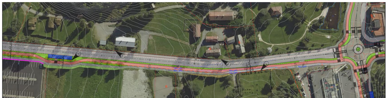
Figur 42: Løsning langs Sverresborg allé der alléen bevares og tilpasset tverrsnitt forbi Wullum gård
