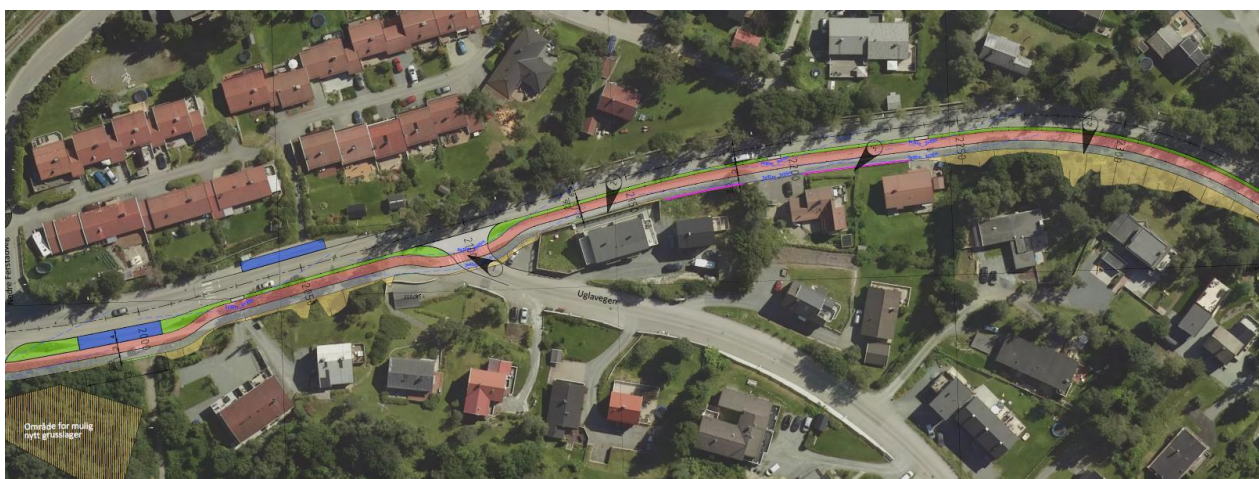
Figur 109: Løsning med sykkelveg med fortau, trafikkdeeler 1 m. Alt.3 er delvis lik alt.2 og medfører en del utslag i sideterrenget
