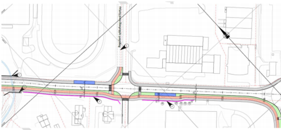
Figur 16: Foreslått kryssløsning for krysset Bromstadvegen/Tungavegen.
