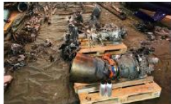
De første detaljerte undersøkelsene av komponentene fra helikopteret som styrtet i Alta, ble gjennomført tirsdag. Komponentene ligger ute i Havarikommissjonens hangar på Kjørli i Luleå, og minnekonferansen fra helikopterulykken er fortsatt til underetats. Enheten var mer varmeskadd enn første observasjon indikerer. Helikopteret fra Airbus Helicopters var av typen AS 350 B3e med kjennetegn 501. Foto: NTB Scanpix
