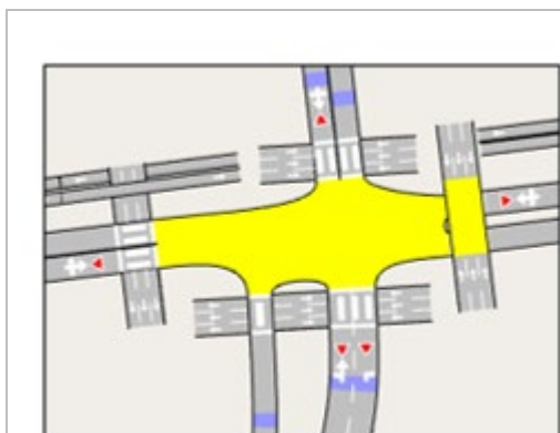
Figur 7 To kjørefelt uten venstresvingefelt i Stadsingeniør Dahls gate (fra øst)
