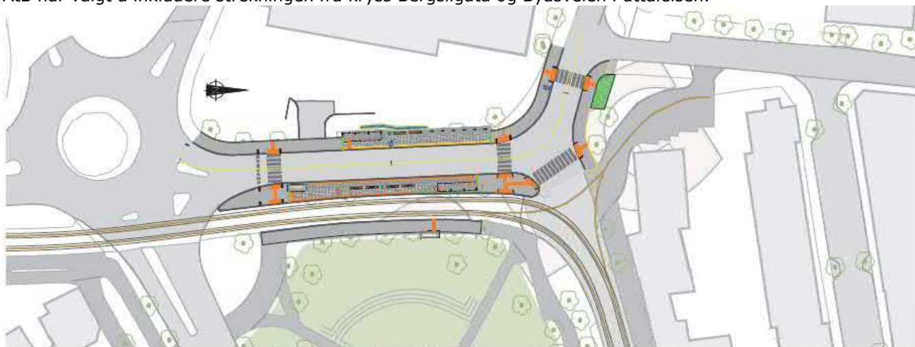
Figur 2: Forslag til ny stasjonsutforming fra silingsrapporten
