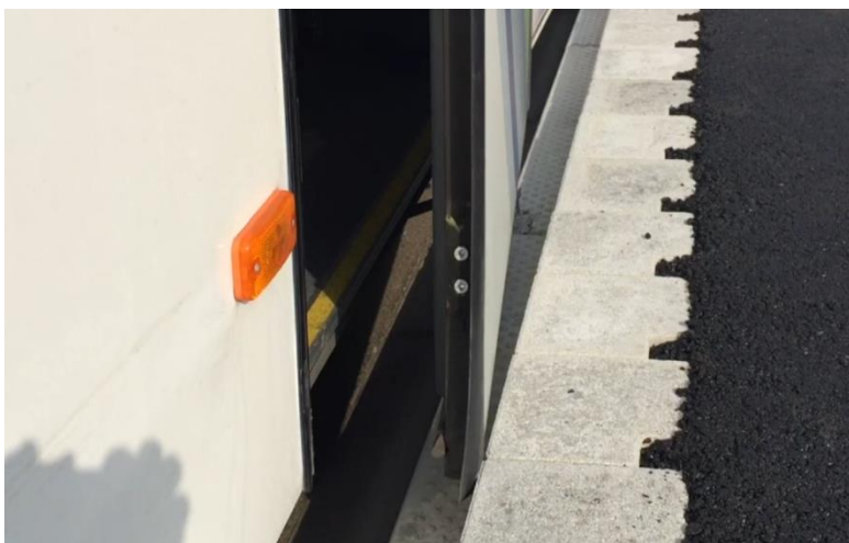
Figur 17 Flybuss ved 26 cm holdeplasshøyde. Foto: Statens vegvesen
