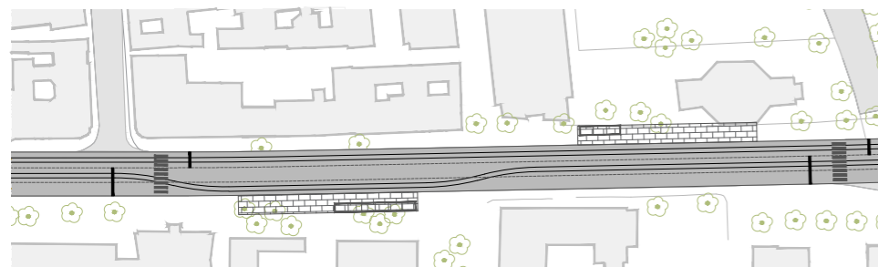
Figur 23: Feltskifte for trikken ved holdeplass i østgående retning.
