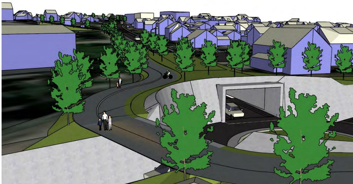
Figur 37: Kulvertportal med planskilt kryssing for gående og syklende
