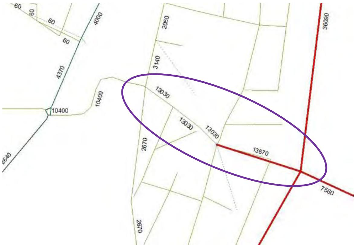
Figur 3: Forventede trafikkmengder med tverrforbindelse
