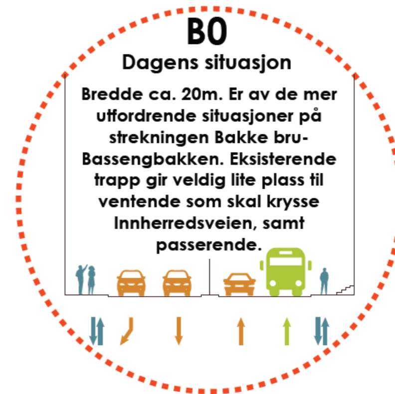
Figur 21 Gatesnitt fra Innherredsveien ved Beddingen. Dagens smale gatesnitt vil gi utfordringer med både å få plass til firefelts veg og oppnå bedre forhold for gående langs gata i tråd med målsettingene i planprogrammet.
