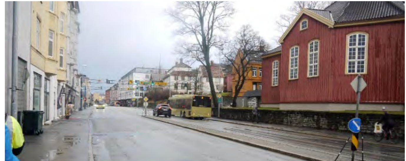
Figur 16 Foto fra Innherredsveien ved Bakke kirke med Bakke gård og Industribygget lengre fram. Bildet illustrerer godt det smale gatetverrsnittet i denne delen av strekningen, med mange kjørefelt og ingen buffer mellom gående og trafikkareal. Foto: Asplan Viak
