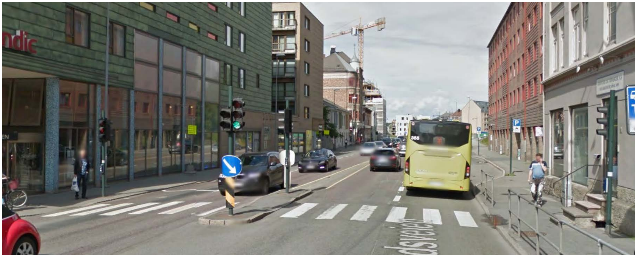
Figur 25 Trappeutstikket til høyre er et typisk element langs Innherredsveien som i punkter gjør fortauene veldig smale. I dette kryssingspunktet er plasseringen ekstra uheldig, siden det sammenfaller med venteområde foran gangfeltet. Gjerdet på bildet er i dag tatt bort for å sikre vinterdrift av fortausarealet. Kilde: Google StreetView
