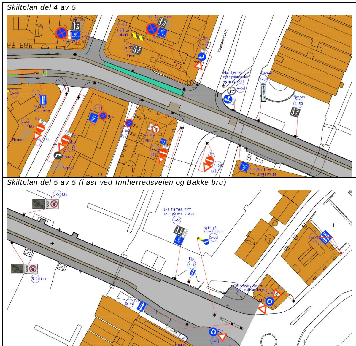
Figur 17: Skilt- og oppmerkingsplan for prøveprosjektet
