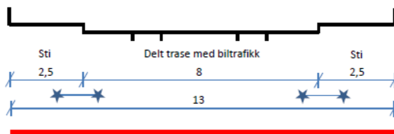
Figur 21: Delt trasé dobbeltspor med biltrafikk
