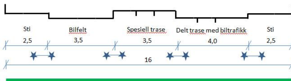
Figur 20: Kombinert Delt- og Spesiell trasé
